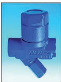
CONA®M Membrankapsel Kondensatableiter aus EN-JL1040, 1.0460, 16Mo3, 1.4305, 1.4301, 1.4541, ASTM-Werkstoffe Anschlussarten: Flansche, Gewinde- muffen, Schweißmuffen, Schweiß- enden, Schweißverschraubung DN 15 bis 50; 1/2" bis 2" PN 6 bis 40; ANSI 150 bis 300
