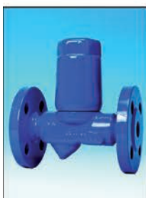
CONA®B Bimetal Kondensatableiter aus EN-JL1040, 1.0460, 16Mo3, 13CrMo44, 10CrMo9-10, X10CrMoVNb91, 1.4541, ASTM-Werkstoffe Anschlussarten: Flansche, Gewindemuffen, Schweißmuffen, Schweißenden, Schweißverschraubung DN 15 bis 50; 1/2" bis 2" PN 16 bis 630; ANSI 150 bis 2500
