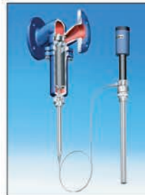
ARI-TEMPROL® Temperaturregler Thermo-Schließ- / -Öffnungs- / Misch- und Verteilventile nach DIN EN 14597 aus EN-JL1040, EN-JS1049, 1.0619+N DN 15 bis 100 / PN 16 bis 40 (CC491K DN 15 bis 50 / PN 16)
