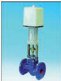
ARI-STEVI® 440 Motor-Regelventil mit Sicherheitsrückstellung bei Spannungsausfall in Durchgangsform aus EN-JL1040, EN-JS1049, 1.0619+N, 1.4408 DN 15 bis 100 PN 16 bis 40
