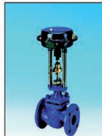
ARI-STEVI® 470 Pneumatik-Regelventil in Durchgangsform aus EN-JL1040, EN-JS1049, 1.0619+N, 1.4408 DN 15 bis 150 PN 16 bis 40
