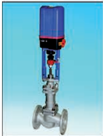
ARI-STEVI® 441 Motor-Regelventil in Durchgangsform (in Faltenbalg-Ausführung) aus EN-JL1040, EN-JS1049, 1.0619+N, 1.4408 DN 15 bis 250 PN 16 bis 40
