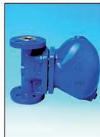
CONA®S Schwimmer Kondensatableiter aus EN-JL1040, EN-JS1049, 1.0460, 16Mo3, 13CrMo4-5, 1.4541, 1.4571, ASTM-Werkstoffe Anschlussarten: Flansche, Gewinde- muffen, Schweißmuffen, Schweiß- enden, Schweißverschraubung DN 15 bis 100; 1/2" bis 2" PN 16 bis 160; ANSI 300 bis 900
