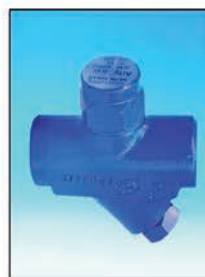
CONA®TD Thermodynamische Kondensatableiter aus 1.0460, 16Mo3, 1.4541, X12Cr13, ASTM-Werkstoffe Anschlussarten: Flansche, Gewinde- muffen, Schweißmuffen, Schweiß- enden, Schweißverschraubung DN 15 bis 50; 1/2" bis 2" PN 40 bis 63; ANSI 150 bis 300
