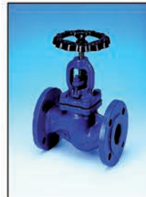
ARI-STOBU® metallisch dichtendes Absperrventil mit Stopfbuchsabdichtung aus EN-JL1040, EN-JS1049, 1.0619+N, 1.4408 wahlweise mit Absperr- oder Drosselkegel DN 15 bis 500 / PN 16 bis 40 DN 10 bis 50 / PN 63 bis 160
