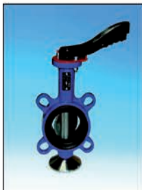
ARI-ZIVA®-Z / ARI-ZIVA®-G für den Industrieinsatz wartungsfreie, weichdichtende Zwischenflansch- / Gewindeflansch-Klappe aus EN-JS1030 wahlweise mit Rasthebel, Schneckenradgetriebe, elektrischen oder pneumatischen Antrieben DN 25 bis 600 / PN 6, 10, 16
