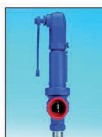
ARI-SAFE TC / TCP / TCS Gewindeventil für Klein- und Kompaktanlagen (SAFE TCS für horizontalen Einbau) aus EN-JS1049, 1.4408, 1.4581 mit Gewindeanschluss nach ISO 228 für Dämpfe, Gase, Flüssigkeiten. Option: Metall- oder EPDM-Faltenbalg DN 15 bis 25 / PN 40 / PN 100
