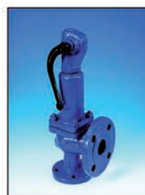
ARI-SAFE / ARI-SAFE P Vollhub-/Normal-Sicherheitsventil wahlweise mit offener oder geschlossener Federhaube aus EN-JL1040, EN-JS1049, 1.0619+N, 1.4408, SA 216 WCB DN 20/32 bis 150/250; 1" bis 6" PN 16/16 bis 40/16; ANSI 150/150 bis 300/150 (nur Vollhub)
