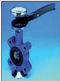
ARI-ZESA® / ARI-GESA® wartungsfreie, weichdichtende Zwischenflansch- / Gewindeflansch-Klappe aus EN-JS1030, wahlweise mit Rasthebel, Schneckenradgetriebe, elektrischen oder pneumatischen Antrieben DN 25 bis 500 PN 10, 16
