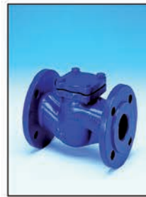
ARI-Rückschlagventil serienmäßig mit Schließfeder aus EN-JL1040, EN-JS1049, 1.0619+N, 1.4408 DN 15 bis 500 PN 6 bis 40
