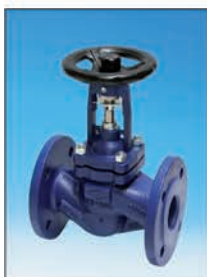
ARI-FABA®-Plus wartungsfreies, metallisch dichtendes Absperrventil mit doppelwandigem Edelstahl-Faltenbalg aus EN-JL1040, EN-JS1049, 1.0619+N, 1.4408, SA216 WCB, SA105 Kantensitz-Kegel, Feingewindespindel DN 15 bis 500; 1/2" bis 10" PN 16 bis 40; ANSI 150 bis 300
