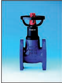
ARI-EURO-WEDI® wartungsfreies, weichdichtendes Absperrventil aus EN-JL1040 serienmäßig mit Drosselfunktion wahlweise als Kappenventil Baulängen: FTF-1 / FTF-14 DN 15 bis 200 PN 6 bis 16
